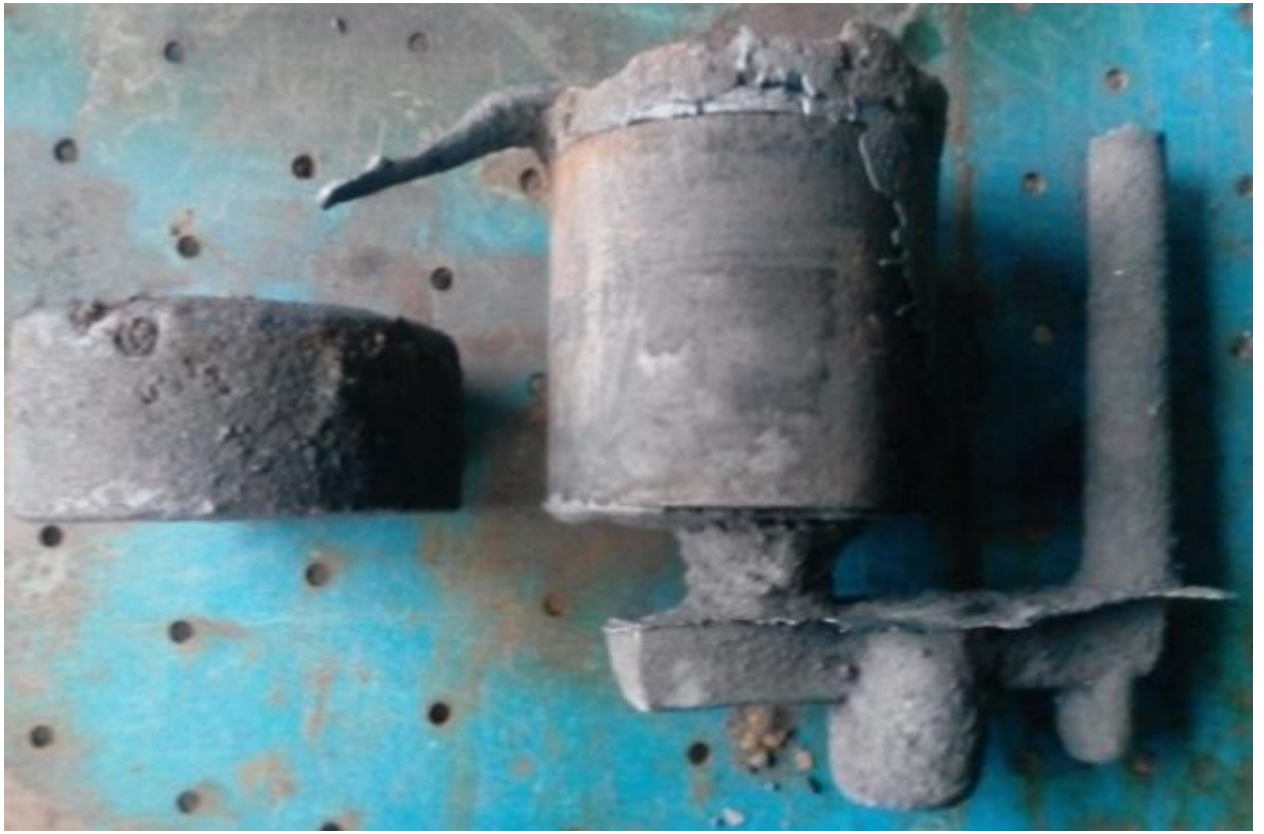
Рисунок 4 - Внешний вид полученной двухслойной отливки «Цилиндр»
